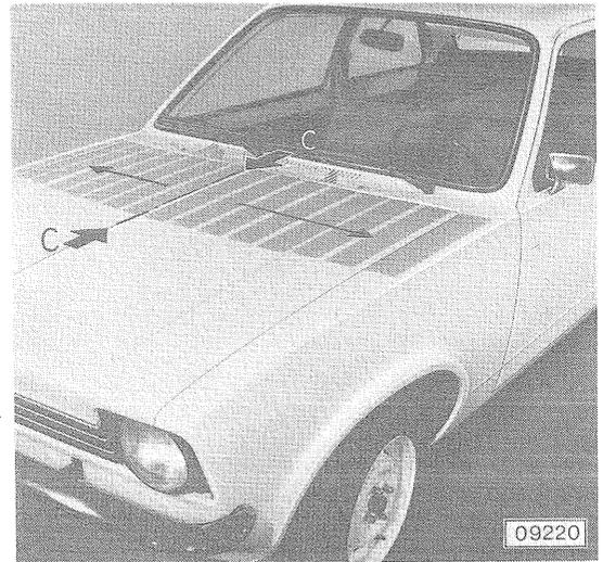
Zierstreifen an Kotflügel und Tür anbringen. Hierzu Zierstreifen mit der Schriftoberkante an der oberen Prägekante des Kotflügels ansetzen. Dabei ist darauf zu achten, daß ein einwandfreier Übergang zur Motorhaube erreicht wird. Zur Kontrolle Zierstreifen nach unten ziehen, bis das Streifenende E mit der Prägekante D (siehe Maßskizze 09230) einwandfrei abschließt. Danach Zierstreifen von unten bis zur Schrift "OPEL" anlösen und von oben nach unten endgültig ankleben.
