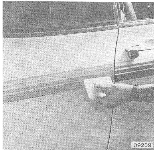
Äußeres Abziehpapier am Zierstreifenende lösen und schräg nach unten wegziehen.
