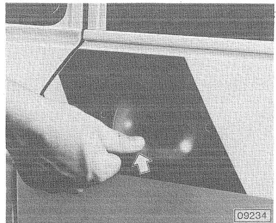
Zierstreifen an der Prägekante der Tür ansetzen und gleichzeitig so ausrichten, daß sich die hintere Beschnittkante des äußeren Abziehpapiers mit der Vorderkante des Einsatzstückes deckt. Zierstreifen, wie prinzipmäßig in Bild 09237 gezeigt, befestigen.
