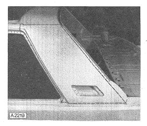
Punktschweißflanschreste entfernen. Befestigungswinkel an den Stellen "A" abschrauben.
