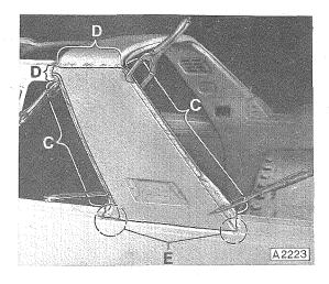
Bügel festschweißen. Im Bereich "C" punktschweißen (mit Elektrodenarmen Nr. 252 Fa. Dalex
