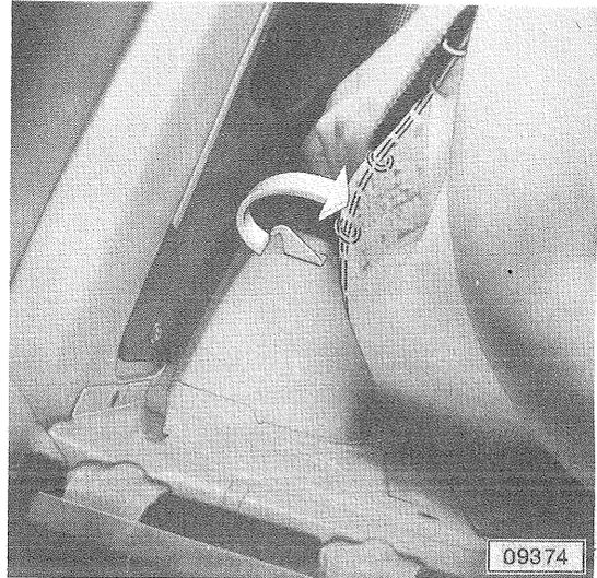
Am Radeinbau unten, den Formdraht nach unten und in Sitzrichtung drücken.
