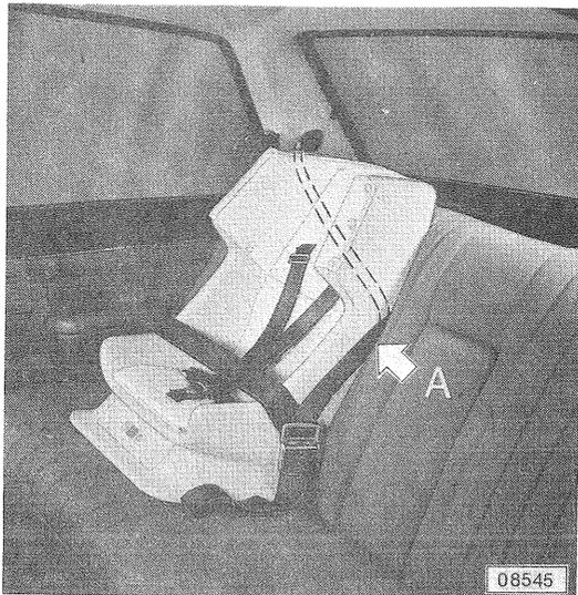
Befinden sich im Fahrzeug bereits Rücksitz-3-Punkt-Sicherheitsgurte, so kann der Kindersitz auch mit diesem Gurt und dem am Kindersitz befindlichen oberen Haltegurt befestigt werden.
