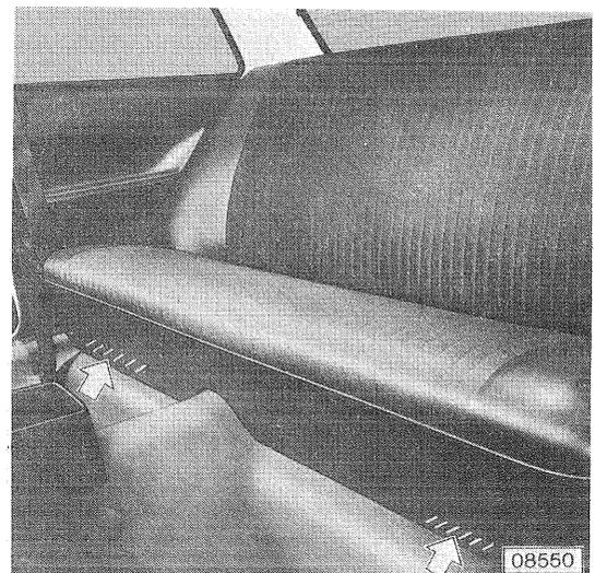
Hinterrücken ausbauen. Hierzu Blechhalterungen "A" unter dem Hinterrücken rechts und links am Radkasten aufbiegen und Hinterrücken aus der oberen Halterung "B" herausheben.
