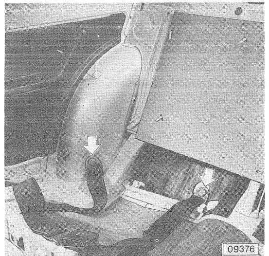
Ausgebauter Rücksitz bzw. ausgebaute Rückenlehne wieder einbauen. Der Einbau erfolgt in umgekehrter Reihenfolge wie der Ausbau.
