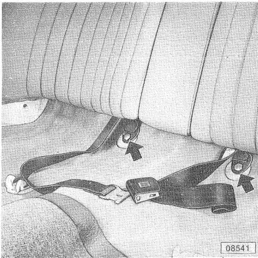
Bild 08541 zeigt die Anordnung des Gurtes in der Mitte des Hintersitzes.
