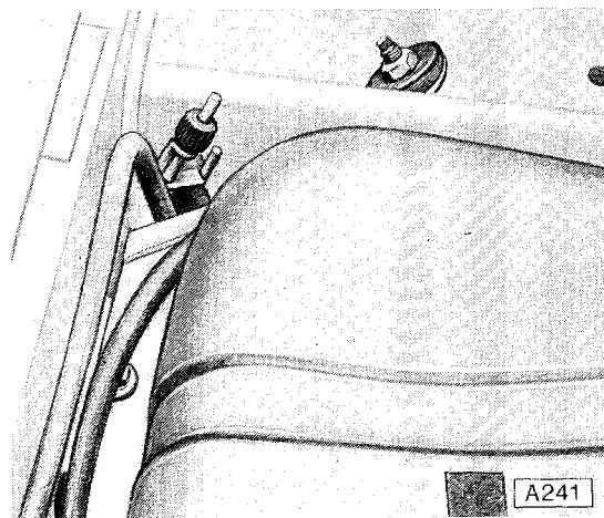
4 Kraftstofftankbefestigungsschrauben abschrauben.
