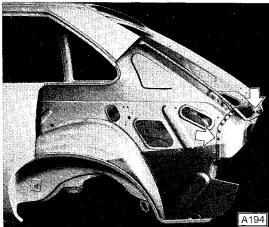
Rückwandversteifung den Trennstellen entsprechend einpassen. Schweißflansche beidseitig blankschleifen. Vor dem Schweißen Punktschweißfarbe, Katalog-Nr. 15 04 553, zum Rostschutz auf Anlageflächen der Schweißflansche auftragen. Rückwandversteifung an den Original-Verbindungsstellen mit der Seitenwand innen und an den Trennstellen punktschweißen.
